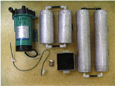
写真2:排水ポンプ、センサー、定期交換部品
