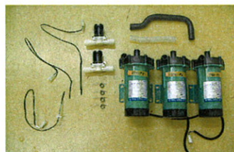
写真2：性能劣化した部品
