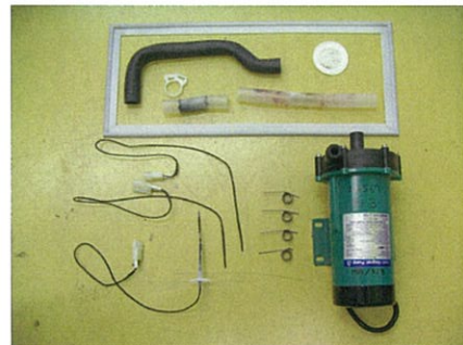
写真2: 配管、水ポンプ、水位センサー、スプリング
