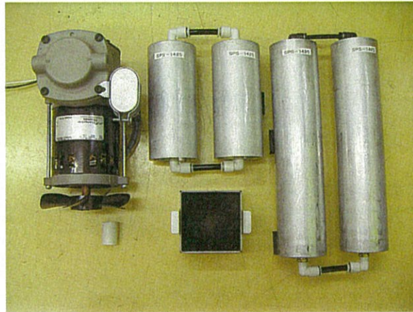
写真1：オゾン分解触媒、PSA（酸素発生装置）部品
