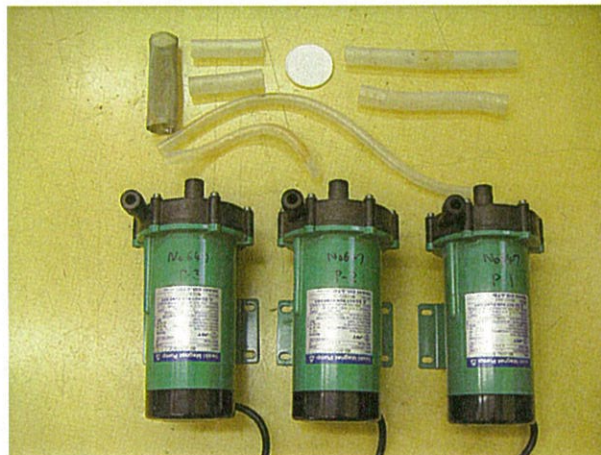
写真2：水ポンプ、オゾン水系統配部品
