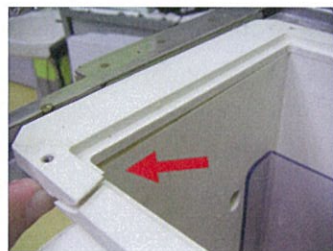
写真1：水槽亀裂部分
