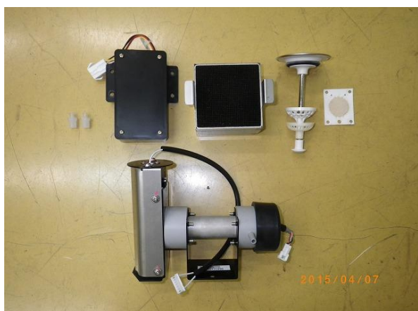
4:ドレンバルブASSY、配管パッキン、フタパッキン ※リークチェック配管(本体側)は写真なし
