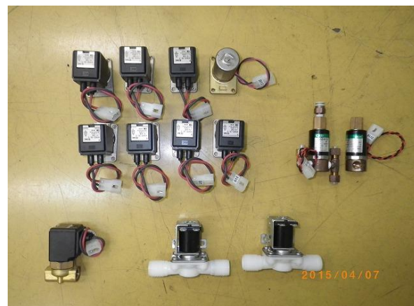
5:マニホールド電磁弁、酸素電磁弁 給水電磁弁、アルコールライン電磁弁
