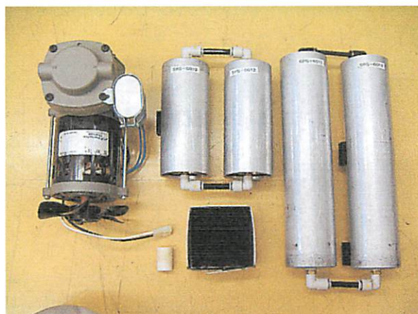
写真1：ドレンフィルター、オゾン分解触媒、PSA（酸素発生装置）部品
