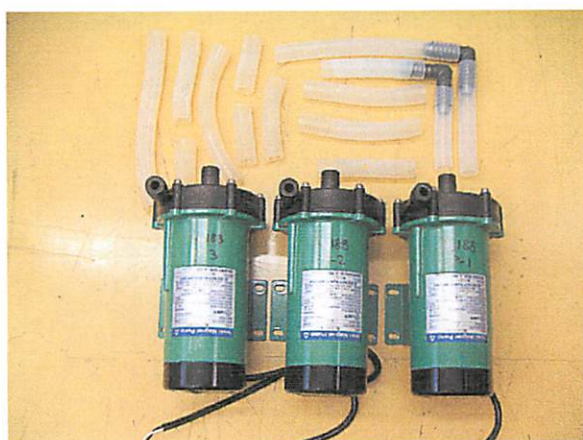
写真2：水ポンプ、オゾン水系統配部品
