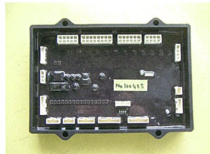
写真1：コントロール基板
