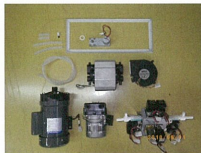
写真 2：メインポンプ、排水ポンプ、排気ファン ほか
