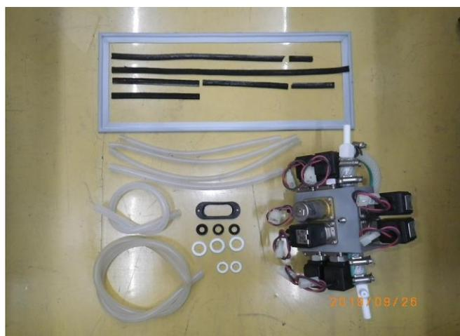
4: 酸素電磁弁、給水電磁弁、アルコールライン電磁弁
