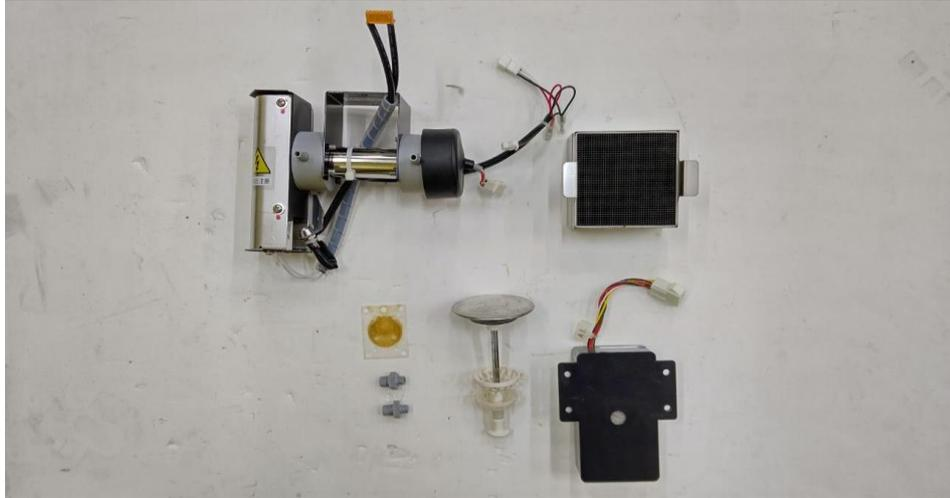
2: メインポンプ、排水ポンプ、エアポンプ、電磁弁(マニホールド、酸素、アルコール、給水)
