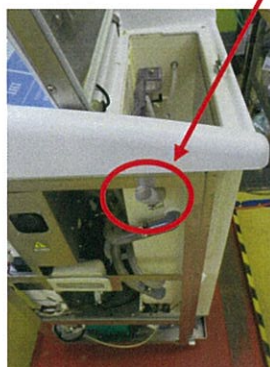
写真2：本体左側 通気配管
