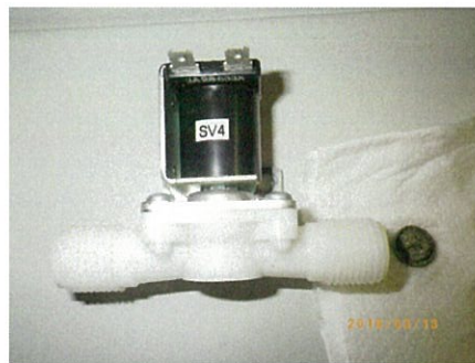
写真2：給水電磁弁のストレーナ
