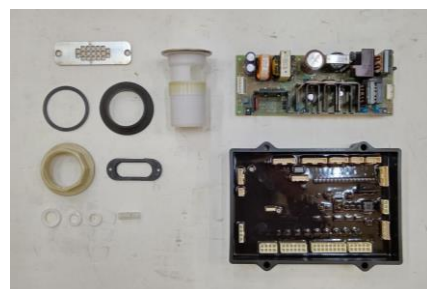
写真3：直流電源、基板、水槽パッキン
