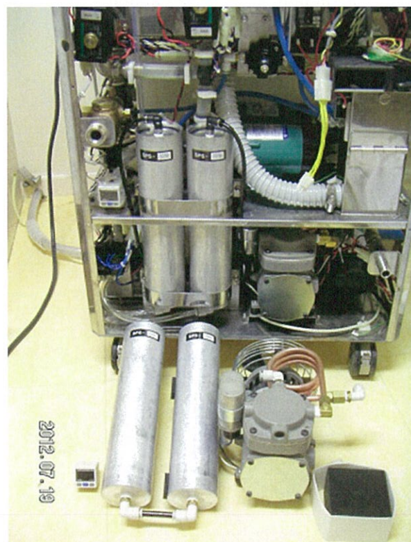
写真2:機械背面側 交換部品・・圧力スイッチ、吸着筒、エアコンプレッサー、オゾン分解食祭
