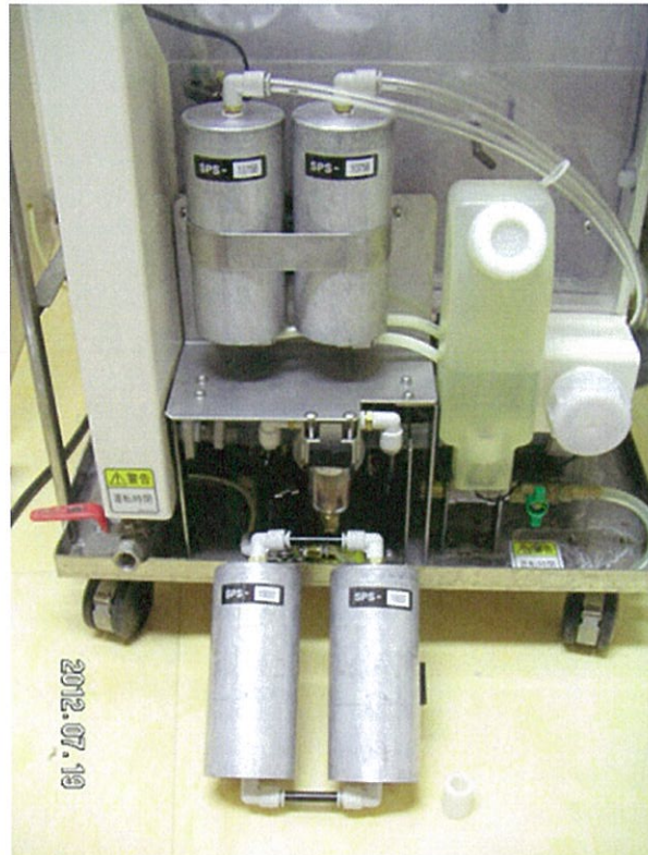
写真1:機械前面側 交換部品・・吸湿筒、ドレンフィルター
