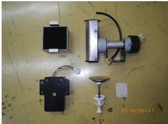
2:コントロール基板、タッチパネル、排水ポンプ、ドレンバルブASSY
