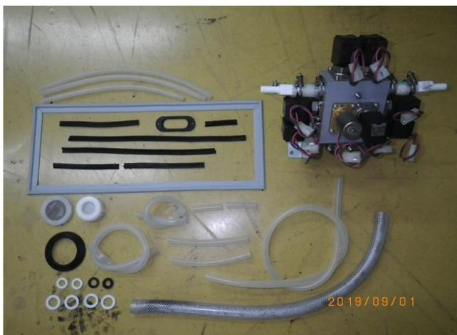
4:メインポンプ、酸素電磁弁、給水電磁弁、アルコールライン電磁弁
