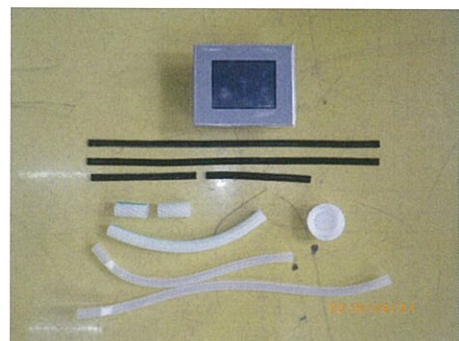
写真2：タッチパネル、配管チューブ、パッキン
