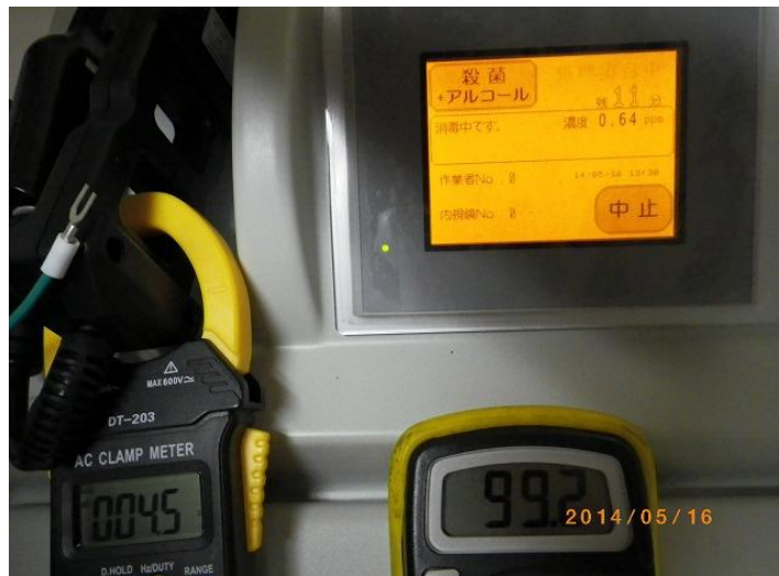
写真3:運転中の電圧、電流測定
