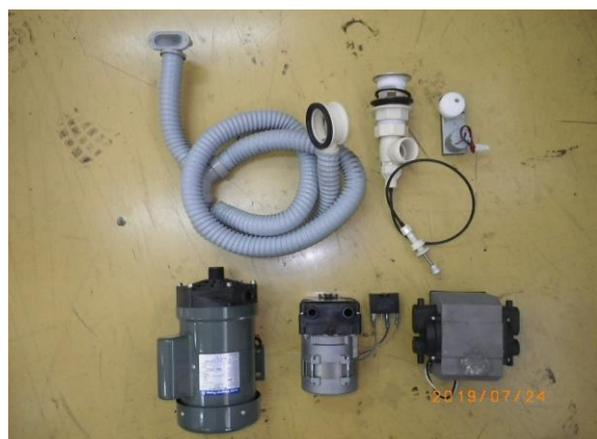
3: マニホールド電磁弁、酸素電磁弁、給水電磁弁、アルコールライン電磁弁、配管パッキン、フタパッキン
