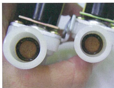
写真2：給水電磁弁入口側
