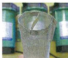
写真1：フィルター破損状況
