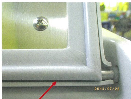
カバーの隙間
