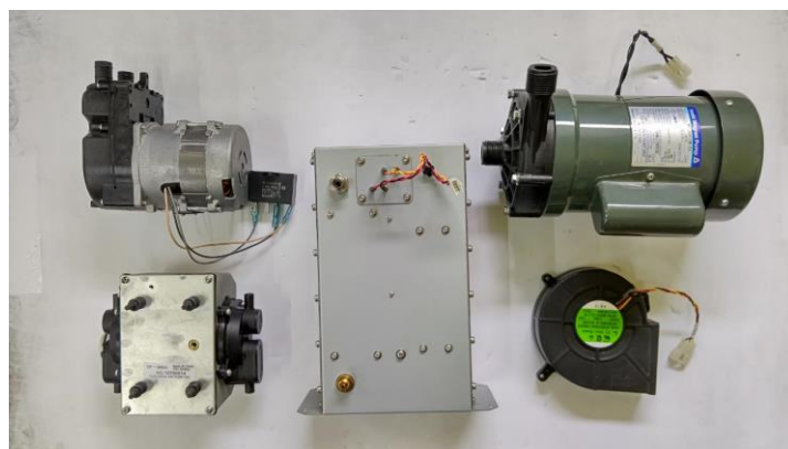
写真4：メインポンプ、エアポンプ、排水ポンプ、オゾン発生機、排気ファン
