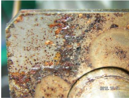
写真10: 排水口金具 付着物除去後
