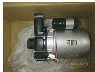
写真2：循環ポンプ 上面
