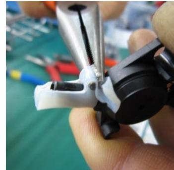
4)40mm~45mm に切っておいたチューブを挿入し、インシュロックを巻く。その後、元の丁字継手に取り付ける。
