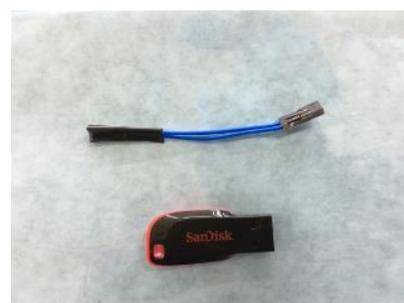
6) 短絡ケーブルとUSBメモリをタッチパネル裏面の基板に取り付ける。
