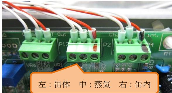
4)電源、蒸気ヒーター、缶体ヒーターの線のカバーを、マイナスドライバー等で横にずらしてから手で外す。
