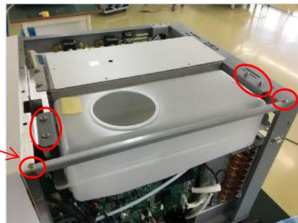
⑥給水タンクの後ろから出ているチューブをインシュロックでフレームから吊るす。
