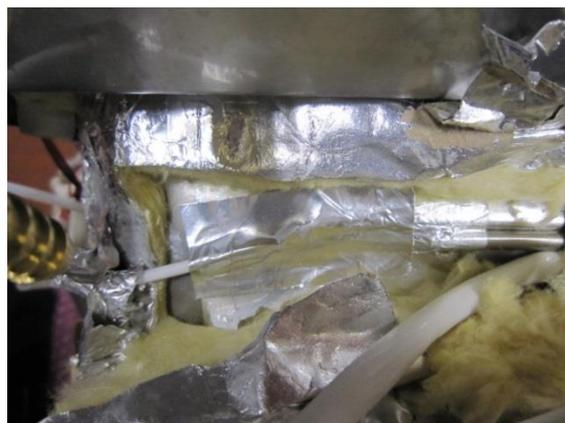
7)めくっていた断熱材を、温度センサーと温度ヒューズ ASSYにかぶせるように戻す。
