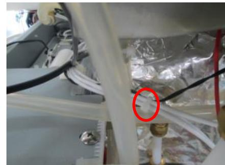
4) 排水タンクの、扉ヒンジ側のすぐそばのアルミテープを剥がし、断熱材を開く。
