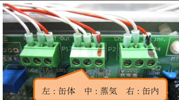
・電源、蒸気ヒーター、缶体ヒーターの線のカバーは、マイナスドライバー等で横にずらしてから手で外す。
