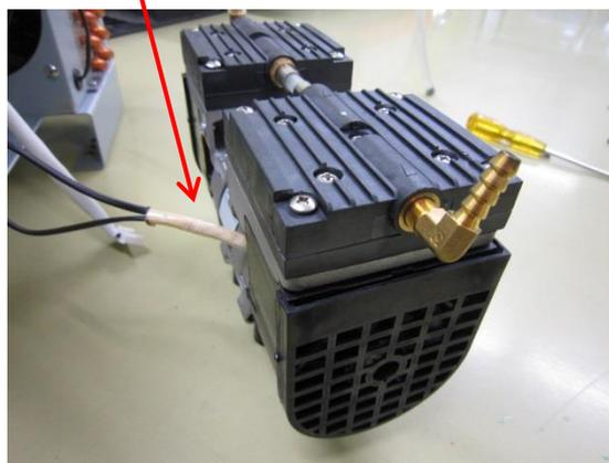
⑥ポンプステイの2ヶ所のネジを短いものに交換する。
