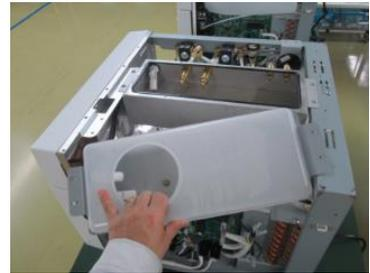
7) 給水タンクを排水タンクの上に置き、テープで固定する。
