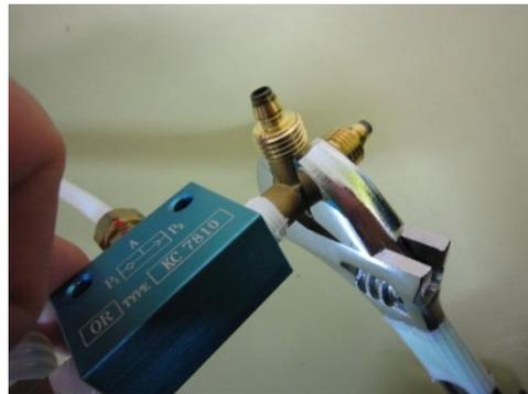
6)ラジエータに取り付け、継手に圧力センサー、テフロンチューブ、シリコンチューブを繋ぐ。
