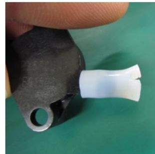
3)切り込みの根元をラジオペンチでつまみ、ひねってチューブを剥ぐ。少し剥いたらまた根元をつかみ、ひねって剥いていく。チューブが外れるまでこれを繰り返す。
