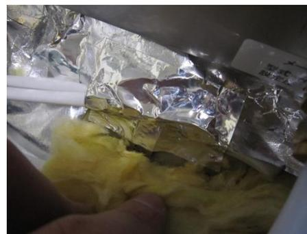
10)めくっていた断熱材を、温度ヒューズ ASSYにかぶせるように戻す。
