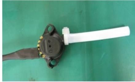
5)T 字継手にセンサーを取り付ける。
