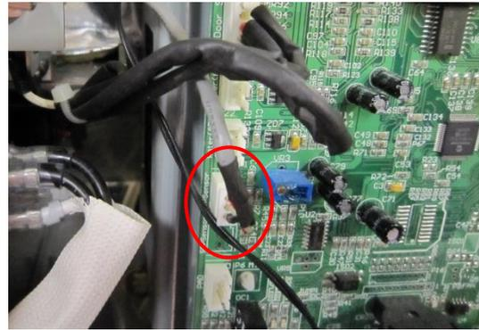
2)センサーの線を束ねているインシュロックを切断する。
