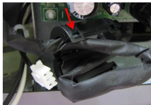
③ 給水ポンプの配線をコネクタから外し、保護チューブ(白いカバー)から抜く。
