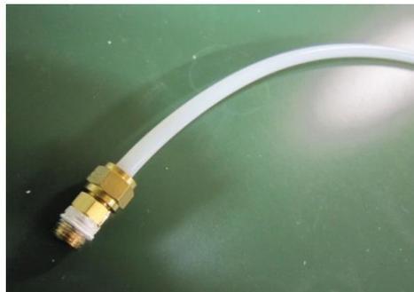
5)外した継手にシールテープを巻き直し、継手を新しいシャトルバルブに付ける。
