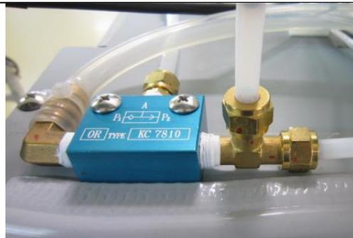
7)ドアロック圧力チューブを取り付ける。コネクタを指でつまんでしっかり締める。
