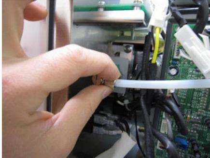
2)フロートスイッチの配線を束ねているインシュロックを切断する。
