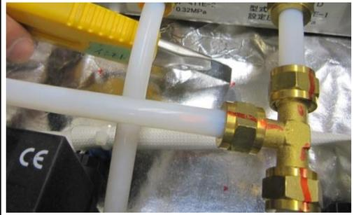
4)缶体温度センサーの先端が、固定バンドから何 mm 出ているかを計測する。
