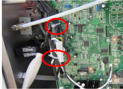
3)精密ドライバーを使い、温度センサーの配線を外す。
