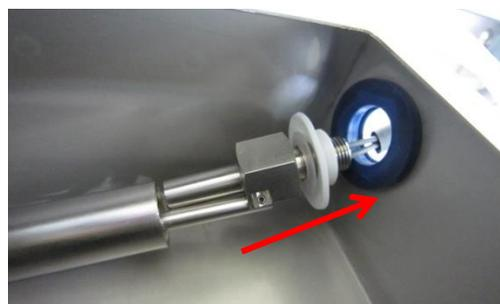
3) ワッシャを挿入し、ナットを締め固定する。
