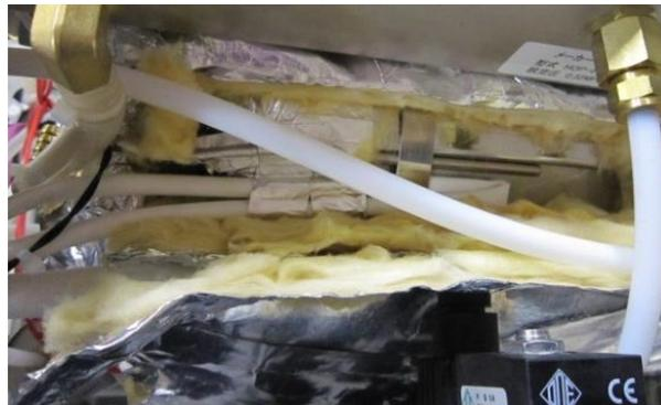
5) 缶体温度センサーを留めているアルミテープを剥がし、筒からセンサーを引き抜く。
